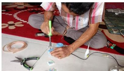
**Gambar 1.** Pembuatan Lubang Pada Galon Fermentasi
