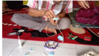
Gambar 2. Pemasangan Selang dan Kran Pada Tutup Galon
